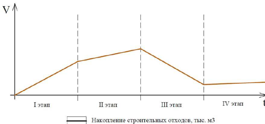
Рисунок 2. График наполнения полигона строительных отходов
